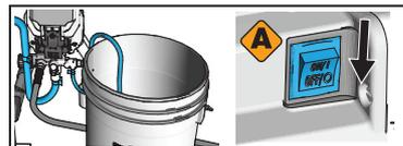
**4** Material für 30–60 Sekunden durch den Saugschlauch und aus dem Ablassrohr fließen lassen. Netzschalter auf OFF stellen.
