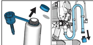
**1** Pump Armor-Flaschenverschluss und Foliensiegelung entfernen. Bei Bedarf Einlasssieb vom Saugrohr schrauben.
