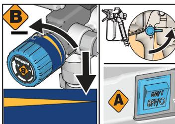
**6** Druckreglerknopf auf die niedrigste Stufe drehen und Abzug loslassen. Abzugssperre verriegeln. Entlüftungs-/Spritzventil auf PRIME stellen und den Netzschalter in die Position OFF bringen.
