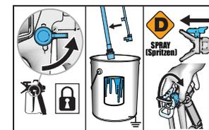
**7** Wenn Farbe aus der Pistole kommt, den Abzug loslassen. Abzugssperre verriegeln. Ablassrohr in Farbeimer bringen und an Saugrohr befestigen. Spritzdüse zurück in die SPRAY-Position drehen und sicherstellen, dass der Spritzdüsenenschutz fest ist.
