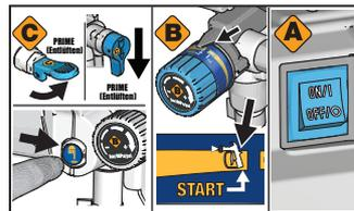
**3** Entlüftungs-/Spritzenventil in die PRIME-Position bewegen. PushPrime-Schalter\* zweimal drücken, um Einlassventilkugel zu lösen. Den Druckreglerknopf auf die START-Position drehen. Netzschalter auf ON stellen.
