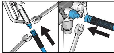
**1** Bei Bedarf Schlauch mit Pistole verbinden. Rote Abdeckung entfernen und dann Schlauch mit Spritzgerät verbinden. Gut festziehen.
