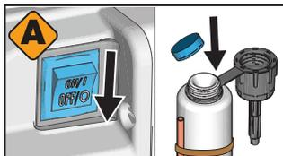
**4** Beim Spülen von Pump Armor durch das Spritzgerät, Netzschalter auf OFF STELLEN. Setzen Sie den Deckel mit Kindersicherung für die Lagerung wieder auf und ziehen Sie ihn fest.
