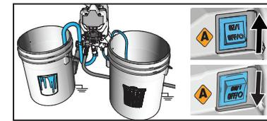
**5** Saugschlauch in die Farbe eintauchen. Netzschalter auf ON stellen und warten, bis Farbe aus dem Ablassrohr austritt. Netzschalter auf OFF stellen.
