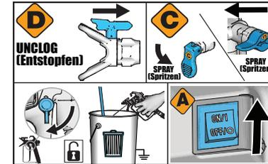
**6** Spritzdüse in die UNCLOG-Position drehen. Abzugssperre entriegeln. Mit Pistole auf den Abfallbehälter zielen, Abzug ziehen und halten. Das Entlüftungs-/Spritzenventil in die SPRAY-Position bewegen und Netzschalter auf ON stellen.
