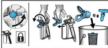
**2** Abzugssperre verriegeln. Spritzdüsenchutzgruppe von Pistole entfernen und in Abfalleimer legen.
