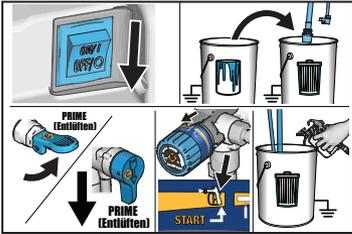
**1** Netzschalter auf OFF stellen. Saug- und Ablassrohr in Abfalleimer geben. Entlüftungs-/Spritzventil in die PRIME-Position bewegen. Den Druckreglerknopf auf die START-Position drehen. Spritzpistole in einen Abfallbehälter auslösen.
