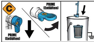
**2** Entlüftungs-/Spritzventil in die PRIME-Position bewegen. Ablassrohr in einen Abfallbehälter geben. Den Druckreglerknopf auf die START-Position drehen.
