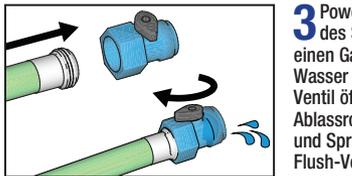
**3** Power Flush-Ventil (im Lieferumfang des Spritzgeräts enthalten) auf einen Gartenschlauch schrauben. Wasser einschalten. Power Flush-Ventil öffnen. Farbe aus Saugrohr, Ablassrohren, Einlasssieb, Spritzdüse und Spritzdüsenchutz spülen. Power Flush-Ventil schließen.
