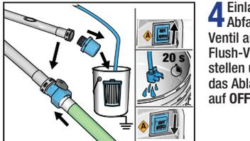
**4** Einlasssieb abschrauben und in einen Abfallbehälter geben. Power Flush-Ventil auf Saugrohr montieren. Power Flush-Ventil öffnen. Netzschalter auf ON stellen und für 20 Sekunden Wasser durch das Ablassrohr laufen lassen. Netzschalter auf OFF STELLEN.
