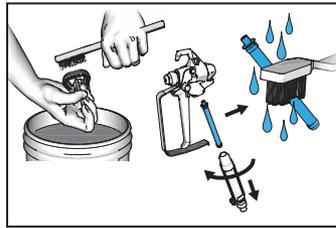
**7** Spritzdüse, Spritzdüsenchutz und Einlasssieb mit einer Bürste reinigen. Spritzpistolenfilter entfernen und reinigen. Spritzpistolenfilter, Spritzdüse und Spritzdüsenchutz wieder einbauen.
