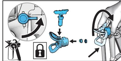
**2** Abzugssperre verriegeln. Sicherstellen, dass Spritzdüse ordnungsgemäß in den Spritzdüsenenschutz eingesetzt ist und die Spritzdüsenchutzgruppe gut an der Spritzpistole festgezogen ist.
