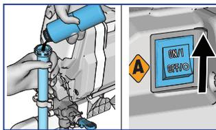
**3** Saugrohr über das Spritzgerät halten, dabei ungefähr 60 ml Pump Armor in das Saugrohr geben und Netzschalter auf ON STELLEN.
