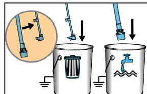
**2** Ablassrohr (kleiner) vom Saugrohr (größer) trennen. Das Ablassrohr in einen Abfallbehälter geben. Saugschlauch bei Materialien auf Wasserbasis in einen mit Wasser gefüllten Behälter eintauchen, oder in Terpentinersatz bei Spritzen von ölbasierten Materialien.
