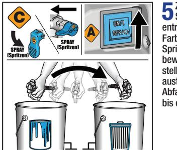
**5** Zum Halten von Farbe im Schlauch, Abzugssperre entriegeln und Spritzpistole in einen Farbbehälter auslösen, Entlüftungs-/Spritzventil in die SPRAY-Position bewegen und Netzschalter auf ON stellen. Falls Wasser aus der Pistole austritt, Pistole auslösen und in einen Abfallbehälter zielen. Solange spülen, bis das Wasser klar wird.
