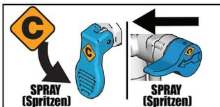
**6** Entlüftungs-/Spritzventil zur Lagerung in die SPRAY-Position bewegen. Netzschalter auf OFF stellen und Netzstecker des Spritzgeräts aus der Steckdose ziehen.
